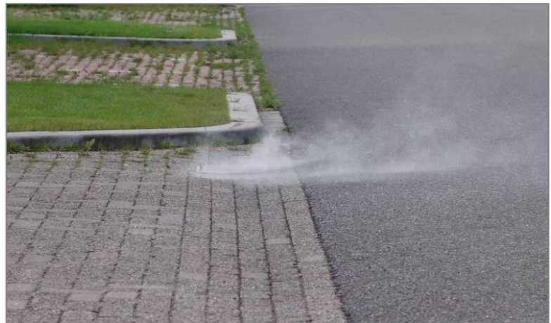
Figuur 3 Rookproef Witte Paal te Schagen (2006)
