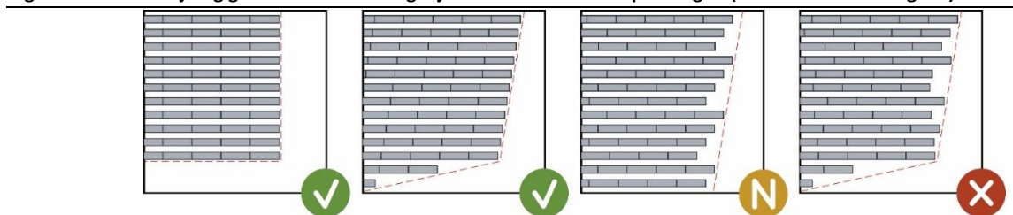
Figuur 10 Uitlijning gebeurt zo recht mogelijk: een van de linker oplossingen (Schematische weergave).
