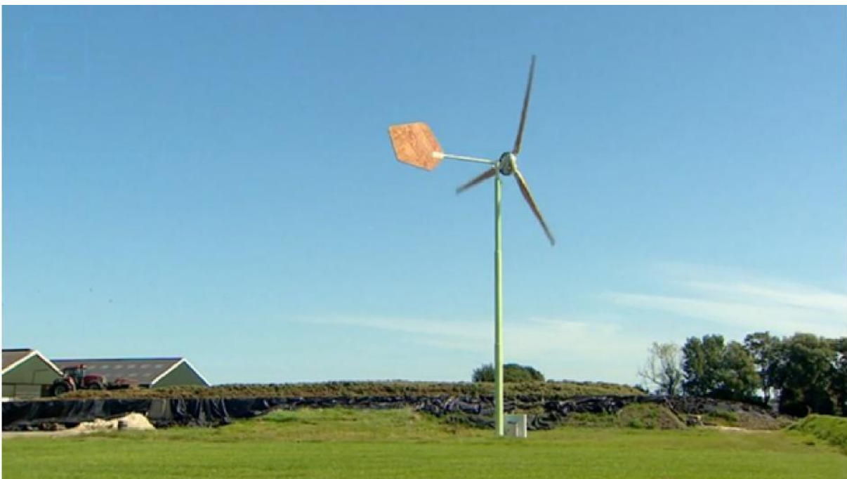
Figuur 2 Een windturbine waarvan de as horizontaal is georiënteerd
