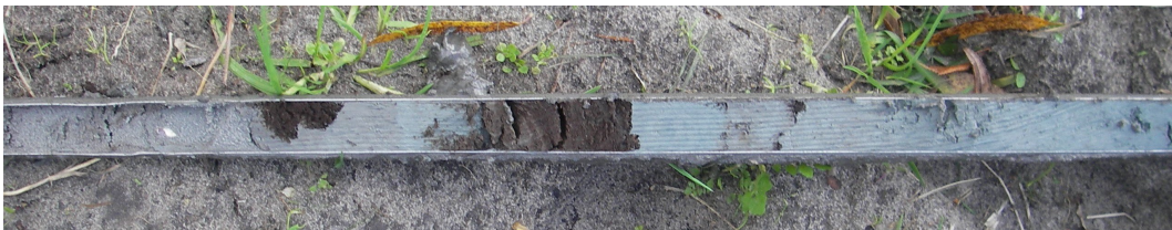
Figuur 8. Callantsoog, Helmweg 10. De geërodeerde veenlaag die in de boringen 1 tot en met 8 en 10 is aangetroffen (in dit geval in boring 8).
