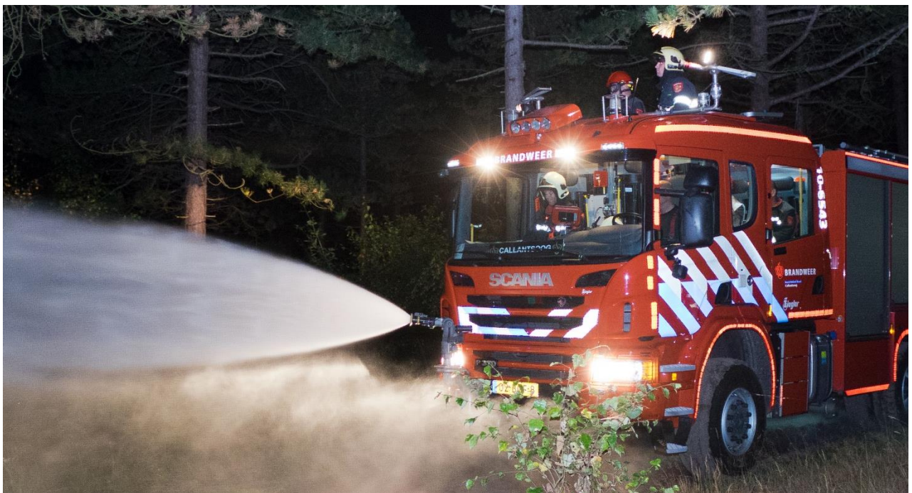
Dankzij de hoge wielen en de vierwielaandrijving kunnen de wagens goed over zanderige paden rijden. De nieuwe tankautospuitten staan in de kazernes van Castricum, Callantsoog en Texel.
