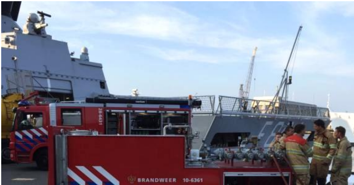
Preventieve inzet van de mobiele schuimblusinstallatie tijdens een lekkage van brandstof.
