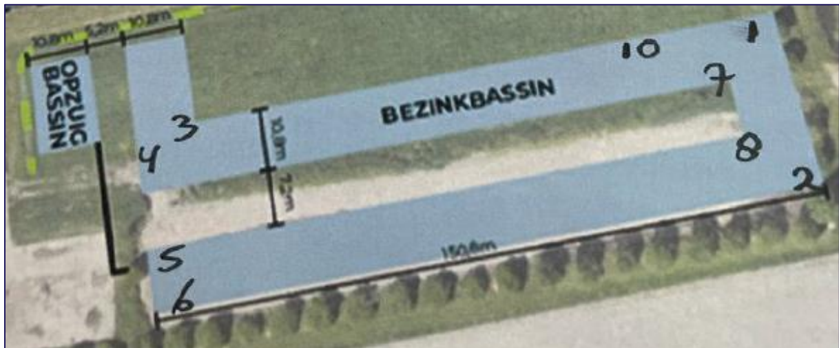
Figuur 5 | Geplaatste peilbuizen en verdamping/ neerslag pan
