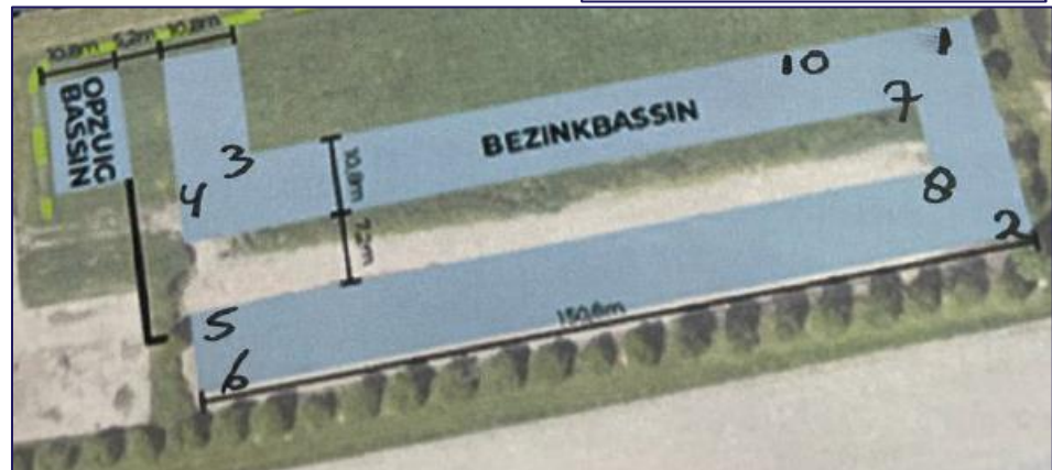
Figuur 11 | Geplaatste peilbuizen en verdamping/ neerslag pan
